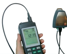
Controle van de meetwaarde-omvormer met 4 .. 20 mA-interface
