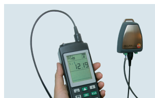
Controle van de meetwaardeomvormer met 4 .. 20 mAinterface
