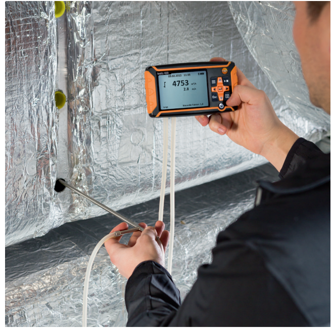
Verwijderbaar meetinstrument voor meer flexibiliteit en pitot buis meting.
