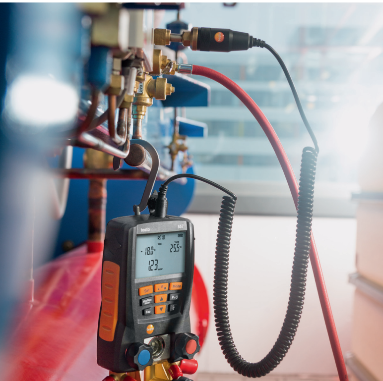
Zeer nauwkeurige vacuum meting: testo 557 met externe sonde
