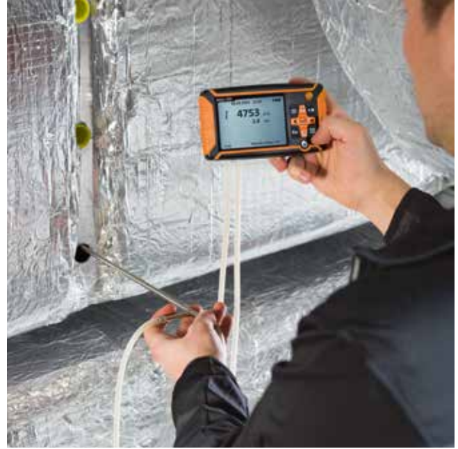
差圧計としてダクト内のピトー管測定 (ピトー管は別途ご注文ください)
