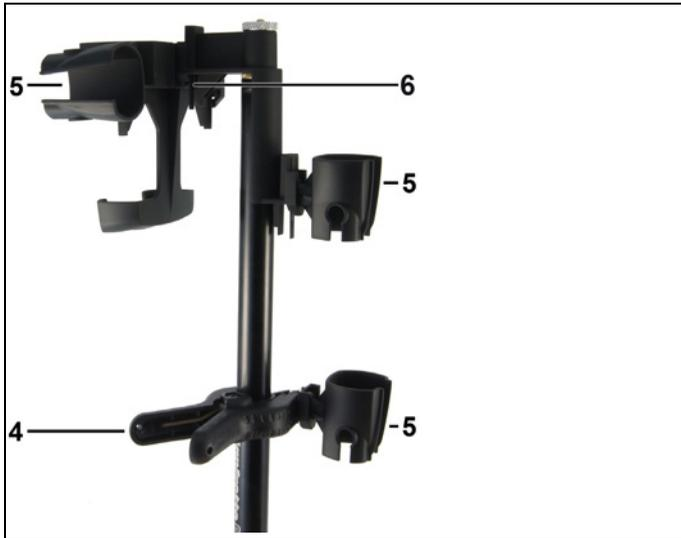
6. Für die Befestigung weiterer Fühler Stativzange (4) an gewünschter Position an Stativrohr festklemmen (z.B. für Turbulenzgradmessung in Knöchelhöhe).
