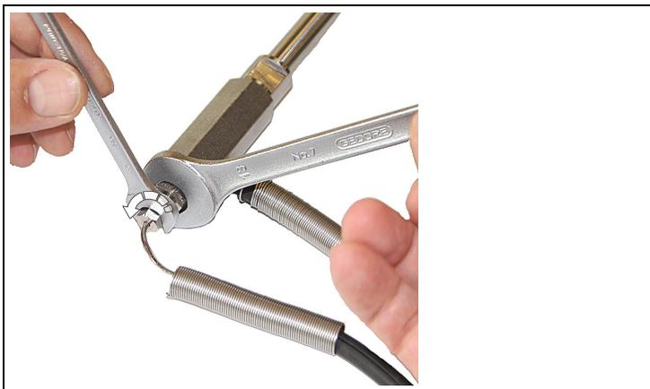
5. Aflojar el tornillo de apriete del termopar con una llave (medida 8).
