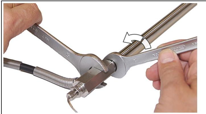
2. Con una llave (medida 13) aflojar el tubo de muestreo del mango, bloqueando éste con otra llave (medida 19).
