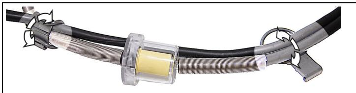
1. Aflojar todas las abrazaderas en la manguera de muestreo de gases.
