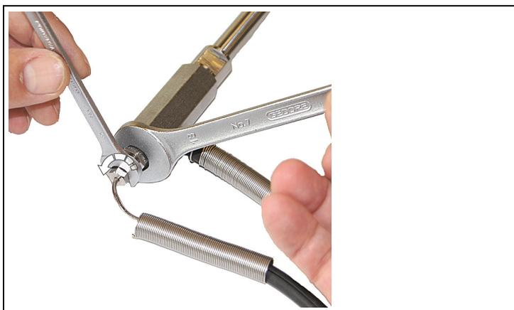
5. Aflojar la atornilladura de apriete del termopar.
