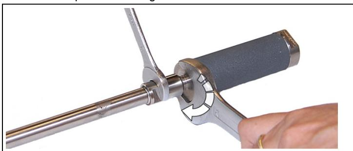
4. Con una llave (medida 17) aflojar el prefiltro del tubo de muestreo, bloqueando éste con otra llave (medida 13).
