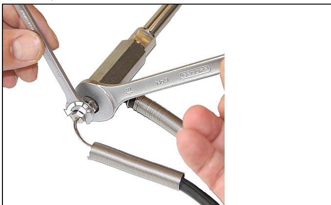
3. Aflojar el tornillo de apriete del termopar con una llave (medida 8).
