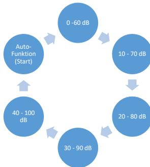
Mit der Einstelltaste „Empfindlichkeit“ kann manuell zwischen den einzelnen Stufen gewechselt werden oder es wird die Auto Funktion zur Anpassung des Pegels gewählt. Die Reihenfolge ist in dem Schaubild links dargestellt.
