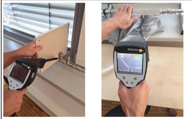
**Überlagerung von Leckagen:** Sollten Leckagen räumlich nah beieinander sein, überlagert sich der emittierte Ultraschall. Hier wird empfohlen, die Leckagen mit einem „Tuch abzudichten“. Speziell bei der Quantifizierung der Leckage erhöht dies die Genauigkeit der Messung enorm. Gleichzeitig sollte hier räumlich sehr nahe an den Komponenten gemessen werden.
