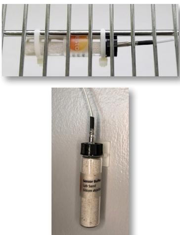
1. Utiliser la sonde (connectée à l'enregistreur de données) pour percer un petit trou sur le dessus du flacon pour tampon de température. Note : la sonde devrait être placée à 90 % à l'intérieur du flacon et 10 % à l'extérieur.
