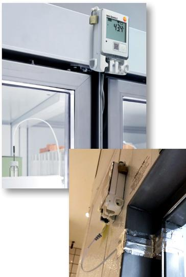
1. Déterminer l'emplacement du support mural et de l'enregistreur de données à l'extérieur du réfrigérateur/congélateur. Le câble doit pouvoir atteindre l'intérieur de l'unité. Vérifier la longueur du câble dans les spécifications.
