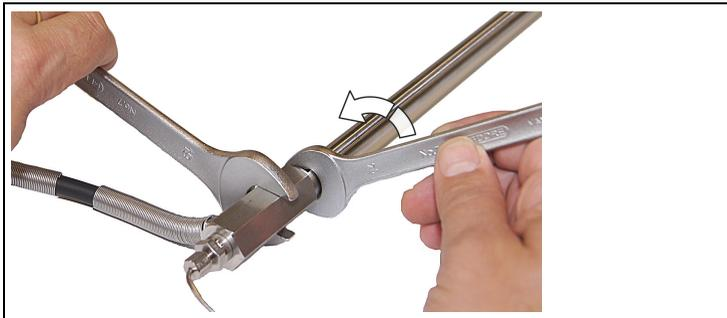
2. mit Schraubenschlüsseln Entnahmerohr (Größe SW13) vom Handgriff (Größe SW19) lösen.
