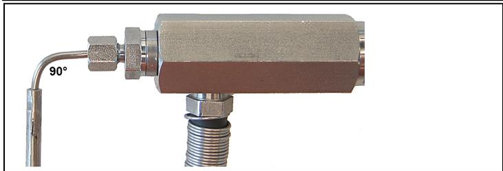
12. Thermoelement zwischen Presshülse und Klemmverschraubung vorsichtig um 90° biegen. Thermoelement nicht knicken.
