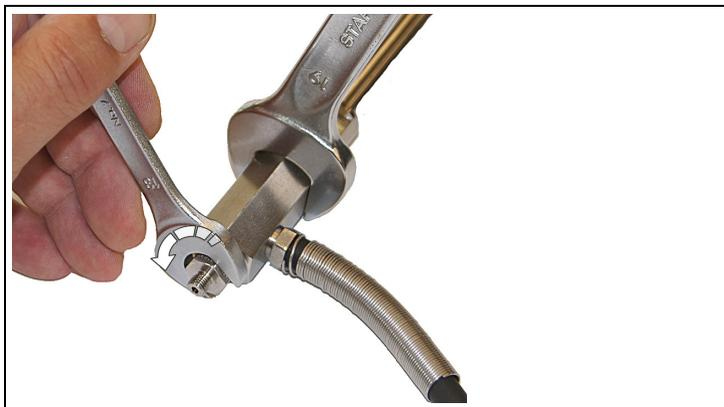
7. Klemmverschraubung mit einem Schraubenschlüssel (Größe SW12) lösen.
