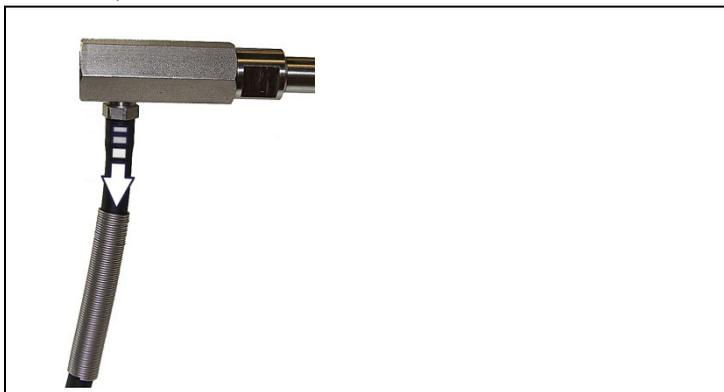
8. Biegeschutzfeder und Gaswegschlauch am Gasweganschluss durch Drehen im Uhrzeigersinn abziehen.
