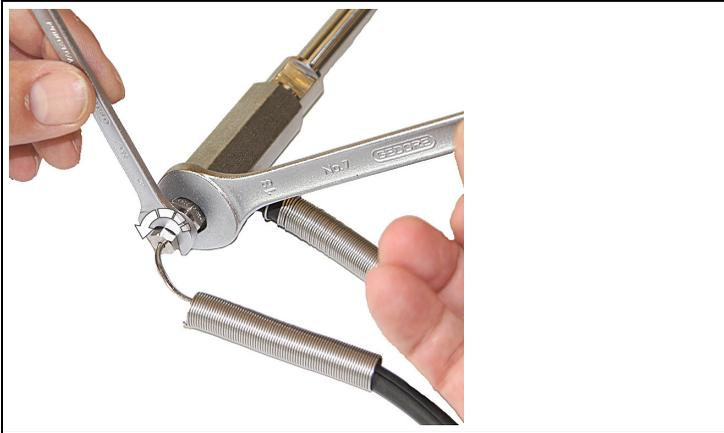
5. Klemmschraube des Thermoelements mit einem Schraubenschlüssel (Größe SW8) lösen.
