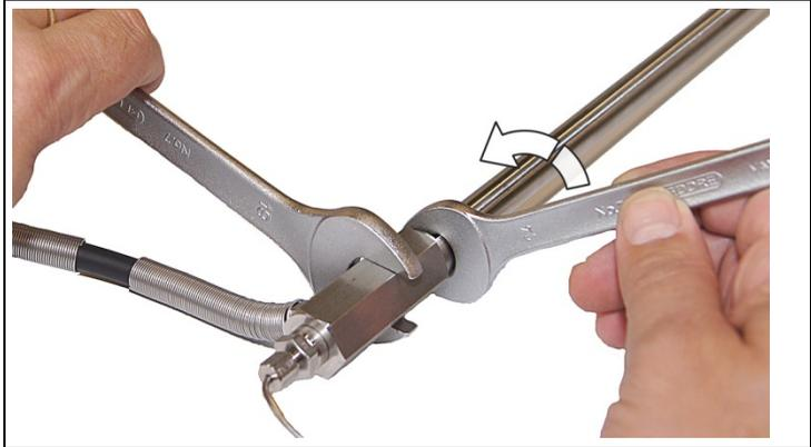
2. Mit Schraubenschlüsseln Entnahmerohr (Größe SW13) vom Handgriff (Größe SW19) lösen.
