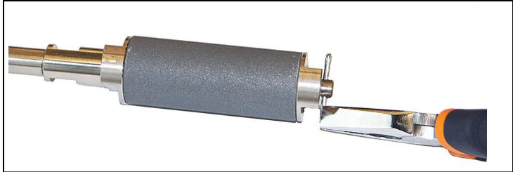
2. Die Enden des Sicherungssplintes mit einer Zange zusammendrücken und nach oben schieben.
