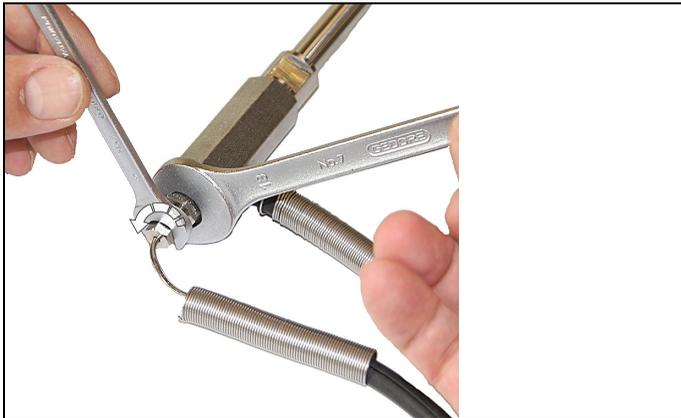
3. Klemmschraube des Thermoelementes mit einem Schraubenschlüssel (Größe SW8) lösen.
