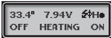
La spia Riscaldamento dà informazioni sullo stato del riscaldamento. Serve anche a controllare la temperatura del sensore. Essa indica la temperatura misurata e la tensione di esercizio dello strumento in °C. Premendo il tasto freccia destro o sinistro sotto la spia On/Off è possibile attivare o disattivare il riscaldamento.
