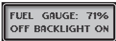
In questo menu è possibile attivare o disattivare la retroilluminazione del display. Viene inoltre visualizzato il valore della carica rimanente della batteria ricaricabile.
