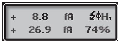
La schermata Dati grezzi indica le correnti misurate nei livelli degli elettrometri; il valore superiore è il livello di diffusione, quello inferiore è il livello di filtraggio. Questi valori non possiedono una correzione dell'offset, non rappresentano cioè i valori realmente misurati, bensì è il valore misurato meno lo slittamento (offset).
