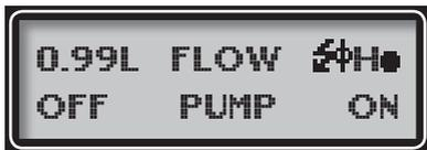
La schermata Portata dà informazioni sullo stato della pompa. La portata viene visualizzata in alto a sinistra. Tener presente che 0.99L di portata tarata di fabbrica corrisponde a 1 litro/minuto. Premendo il tasto freccia destro o sinistro sotto la spia On/Off è possibile attivare o disattivare la pompa.
