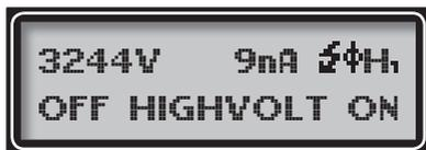
La schermata Alta tensione dà informazioni sulla tensione e sulla corrente presenti sul filo della corona per la carica delle particelle. Premendo il tasto freccia destro o sinistro sotto la spia On/Off è possibile attivare o disattivare l'alta tensione. Se l'alta tensione è disattivata, il testo DiSCmini funge da elettrometro per aerosol se vengono sommate tra loro le correnti di entrambi i livelli.
