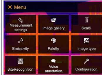
2 Konfiguration [Configuration] auswählen (Joystick oder Touchscreen).
