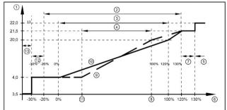
Ausgangskennlinie Analogausgang nach Norm IEC 60947-5-7
