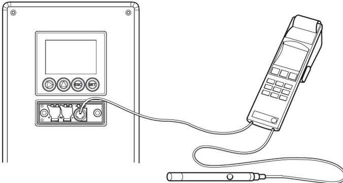
1. Testo Handgerät 400/650 (1) mit angeschlossenem Feuchte-Referenzfühler (3) (Best.-Nr. Referenz-Set 0699 3656/20) über den Abgleichadapter (2) (Anschluss an Fühlerbuchse 1 des Handgeräts) an die Service-Schnittstelle (5) des testo 6383 anschließen.
