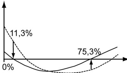
Beim 2-Punkt-Abgleich werden die Abweichungen des Messwertes vom Sollwert über den gesamten Messbereich minimiert. Daher ist der 2-Punkt-Abgleich bei großen Arbeitsintervallen zu empfehlen.
