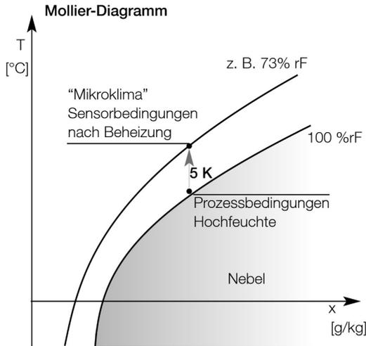
Beim testo 6614 wird der Testo-Feuchtesensor auf seiner Rückseite beheizt, sodass sich rund um den Sensor (innerhalb des Filters) ein Mikroklima ergibt, das konstant um 5 K wärmer ist als die tatsächlichen Prozessbedingungen.
