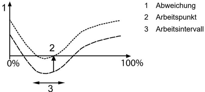
Der Vorteil des 1-Punkt-Abgleichs ist das gute Messresultat im Arbeitsintervall. Je weiter sich die Messung jedoch vom Arbeitspunkt entfernt, desto größer kann die Abweichung werden. Deshalb sollte der 1-Punkt-Abgleich nur bei einem relativ engen Mess-
