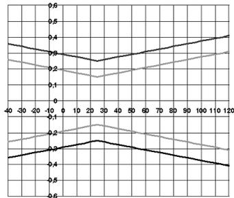
graue Linie: Systemfehler 6383 + Fühler, Elektronik  $25^{\circ}C/+77^{\circ}F$
