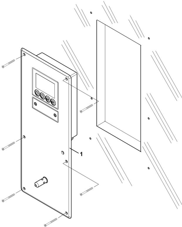
4. Dichtungsrahmen (1) über den Rand des 6383 ziehen.
