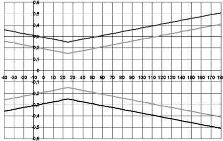
graue Linie: Systemfehler 6383 + Fühler, Elektronik 25 °C/+77° F
