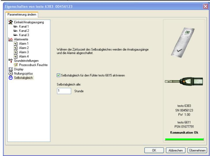
Selbstabgleich für den Fühler testo 6615 aktivieren
