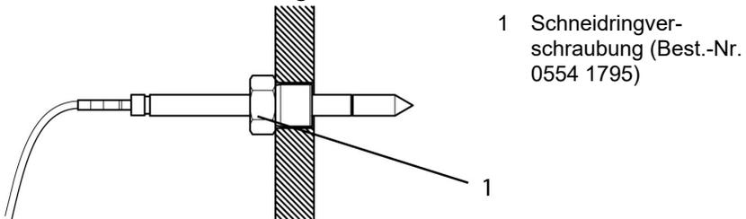
Bei der Installation darauf achten, dass der Fühler während des Betriebs nicht beschädigt werden kann.
