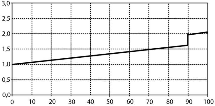
Temperaturfehler in Abhängigkeit von der Prozesstemperatur und der Elektroniktemperatur
