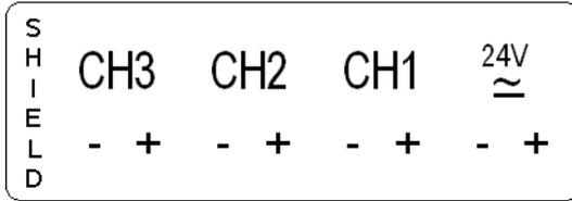
Anschlussleiste für Spannungsversorgung und Analogausgänge, Pos. (1) der Anschlussübersicht
