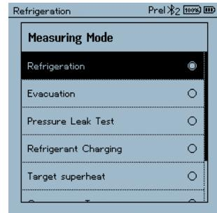
3 Con **[▲]** / **[▼]** seleccionar **Pressure Leak Test (Test de estanqueidad)** y confirmar con **[Menu/Enter]**.
