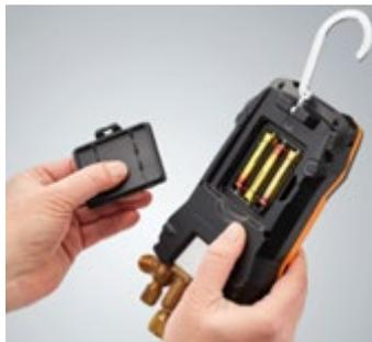
2 Retirar las pilas descargadas e insertar pilas nuevas (3 del tipo AA Alcalina) en el compartimiento de las pilas. ¡Prestar atención a la polaridad!
