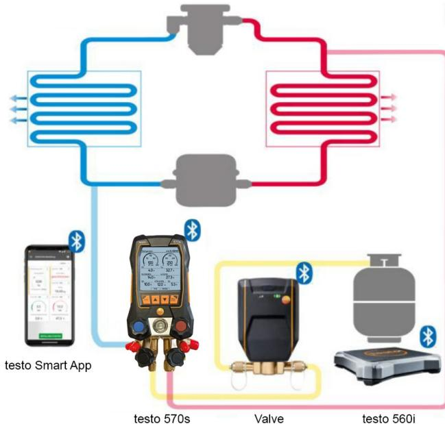
En combinación con el **testo 560i** y la **testo Smart Valve**, el **testo 570s** ofrece varias funciones para el llenado de circuitos de refrigerante.
