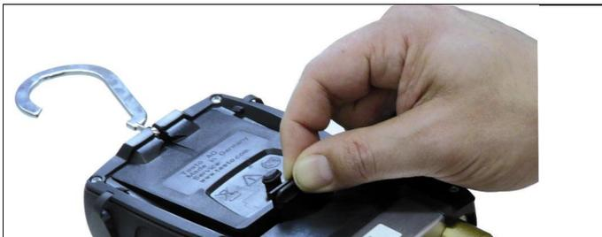
1. Die Aufhängevorrichtung ausklappen, Clip lösen und den Deckel des Batteriefachs entfernen.
