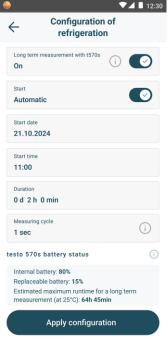
Si la opción para la medición a largo plazo está activa, el menú de configuración muestra información sobre la carga restante de la pila y la batería, así como el posible tiempo de ejecución máximo de la medición a largo plazo.
