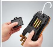
Soltar los 6 tornillos marcados y retirar la parte trasera del instrumento.
