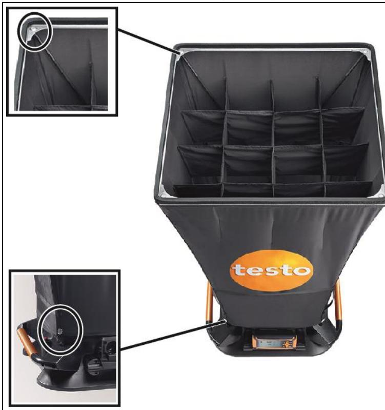
1. Avvolgere l'estremità inferiore del cono intorno allo zoccolo di misura.
