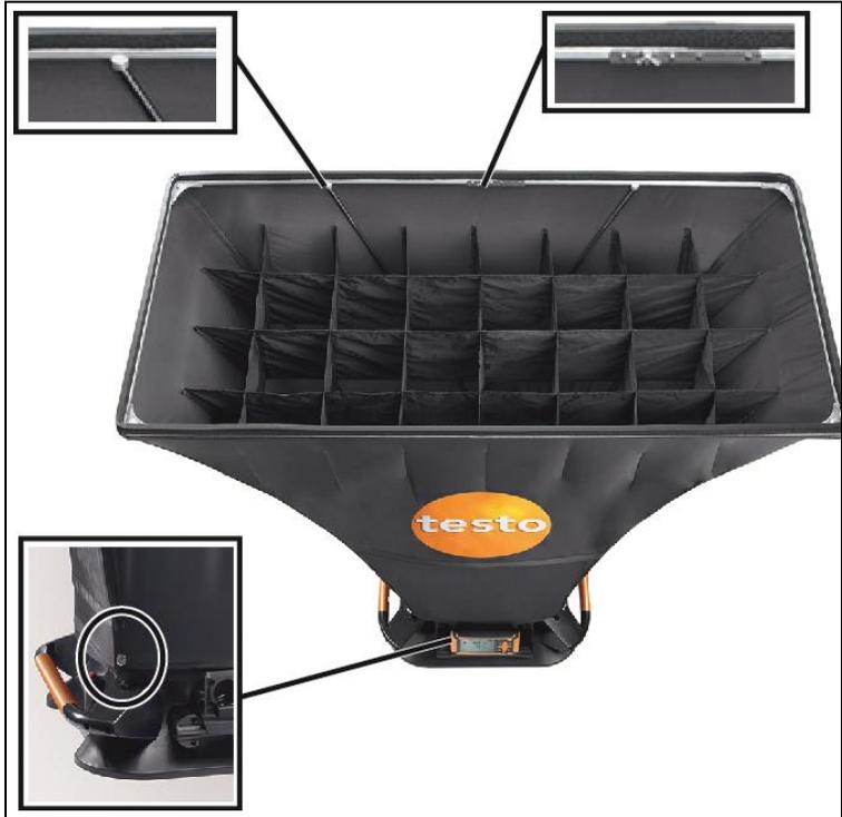
1. Montare il telaio in alluminio e tendere il cono di stoffa sul telaio in modo che il nastro in gomma scorra nella cavità del telaio. Accertarsi che il nastro in gomma sia correttamente fissato in sede, specialmente negli angoli.
