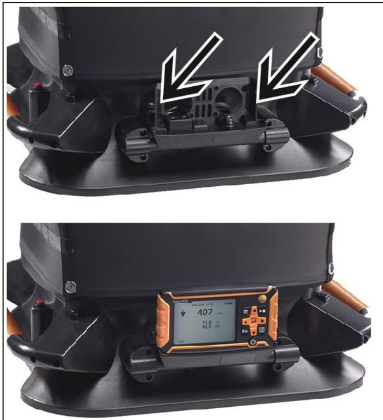
1. Infilare lo strumento testo 420 completamente nell'apposita sede, facendo attenzione agli arresti a destra e a sinistra.
