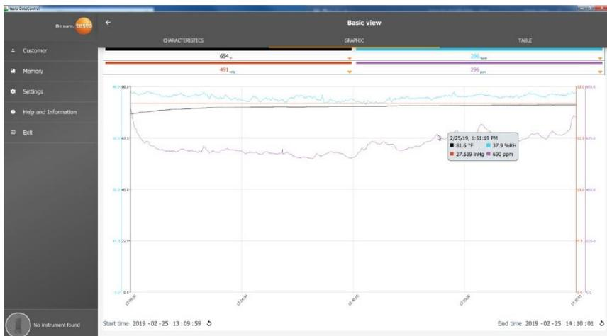
Lorsqu'on clique sur l'un des quatre canaux, une sélection des paramètres de mesure enregistrés pendant la mesure s'ouvre. Les paramètres de mesure peuvent être attribués facilement aux différents canaux grâce à l'ID de la sonde et à l'unité de mesure ou bien sélectionnés comme **pas affectés (not assigned)**.
