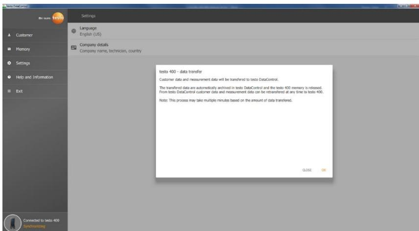
Dès que le testo 400 est relié à un ordinateur par le câble USB, **Connecté au testo 400 – Synchroniser (Connected to testo 400 – Synchronizing)** s'affiche en bas à gauche.
