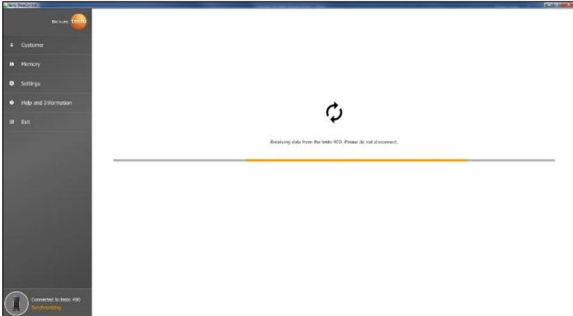
Durch Klicken auf **Schließen**, kann die Software normal verwendet werden, allerdings werden keine Daten von der Software aufs testo 400 übertragen. Um den Datentransfer manuell zu starten, unten links auf **Synchronisieren (Synchronizing)** klicken. Es erscheint kein Hinweis zur Datenübertragung vom Gerät und die Synchronisation beginnt sofort.
