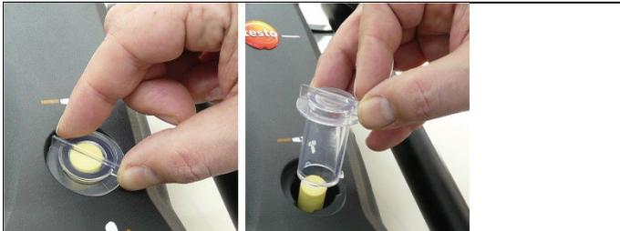
1. Ouvrir la chambre du filtre : Tourner le couvercle du filtre dans le sens contraire aux aiguilles d'une montre et le retirer.
