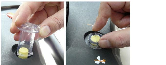
3. Mettre le couvercle du filtre en place et le verrouiller en le tournant dans le sens des aiguilles d'une montre. La barre transversale du couvercle du filtre doit être parallèle à la poignée.
