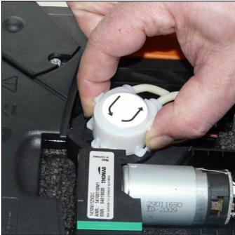
2. Déverrouiller les deux clips latéraux de la pompe à condensat et retirer la tête de la pompe.
