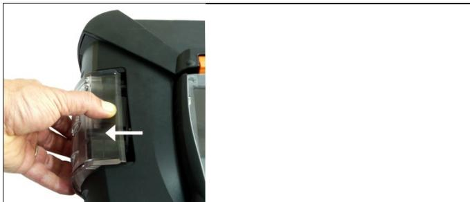
2. Retirer le pot de condensation / réservoir de condensat à l'horizontale hors du coffret d'analyse.
