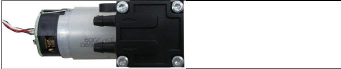
4. Desserrer les 4 vis de fixation (clé Torx T9) de la tête de la pompe à gaz principale.
