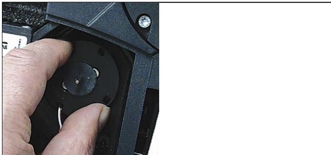
4. Détacher le moteur de la pompe à condensat (courte rotation dans le sens contraire aux aiguilles d'une montre).
