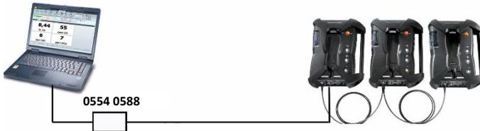
Les différents composants (p.ex. la Control Unit et le coffret d'analyse ou le coffret d'analyse et un autre coffret d'analyse) peuvent être reliés via le câble du bus de données Testo.
