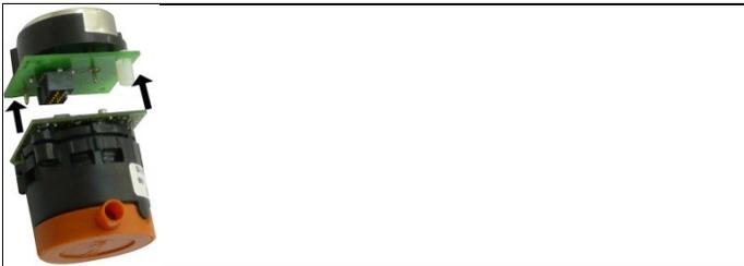
**i** Ne retirer la platine supplémentaire du capteur NO que directement avant le montage. Ne pas laisser le capteur plus de 15 minutes sans platine supplémentaire.
