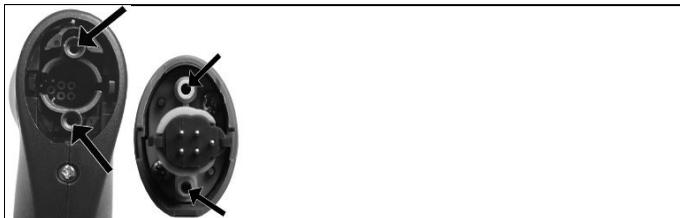
2. Soufflez les conduits de gaz de la sonde modulaire, ainsi que la poignée au moyen d'air comprimé (cf. illustration). N'utilisez aucune brosse!
