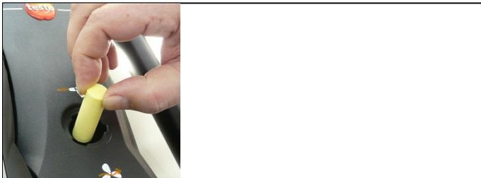
2. Retirer le filtre de protection et le remplacer par un filtre de protection neuf (0554 3381).
