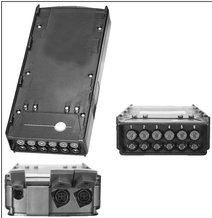
Jusqu'à 6 canaux de mesure peuvent être émis sous la forme de signaux analogiques (4 à 20 mA) via le coffret de sortie analogique 0554 3149 (accessoires). Le coffret de sortie analogique est raccordé à l'appareil via le bus de données ; la configuration peut être effectuée via l'unité de contrôle.
