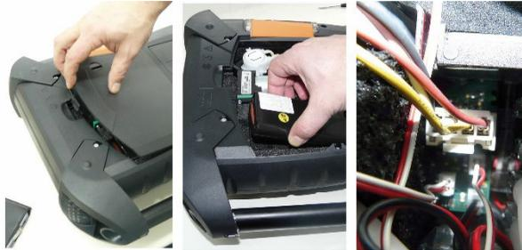
1. Ouvrir le couvercle du compartiment de service (fermeture par clip) à l'arrière du coffret d'analyse.
