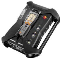
La Control Unit peut être enfichée sur le coffret d'analyse.
