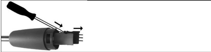
2. Détachez l'embout du thermocouple de son logement au moyen d'un tournevis et retirez le thermocouple du tube.
