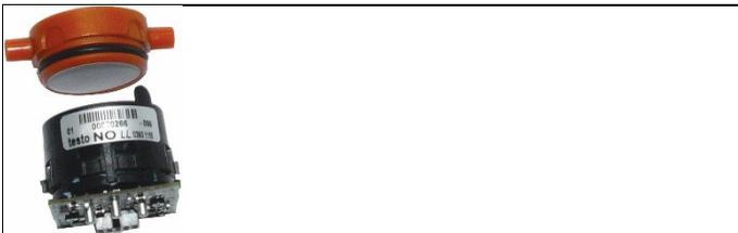
7. Mettre un nouveau filtre en place sur le capteur.
