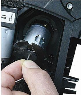
5. Motor der Kondensatförderpumpe aus der Halterung entnehmen.
