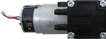
4. Die 4 Befestigungsschrauben (Torxschlüssel T 9) am Pumpenkopf der Hauptgaspumpe lösen.
