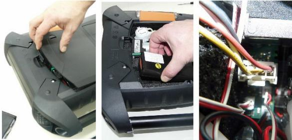
1. Deckel des Servicefachs (Clip-Verschluss) auf der Rückseite der Analysebox öffnen.
