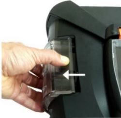
2. Kondensatbehälter waagrecht von der Analysebox abziehen.
