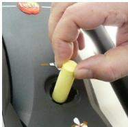
2. Verbrauchten Schmutzfilter entnehmen und durch neuen Schmutzfilter (0554 3381) ersetzen.
