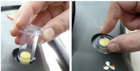
3. Filterdeckel aufsetzen und durch Drehung im Uhrzeigersinn verriegeln. Der Quersteg des Filterdeckels muss parallel zum Handgriff verlaufen.
