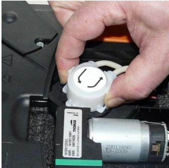
2. Die beiden seitlichen Clipverschlüsse der Kondensatförderpumpe entriegeln und Pumpenkopf abziehen.
