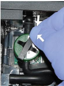
9. Bügel in Halterung einsetzen.
