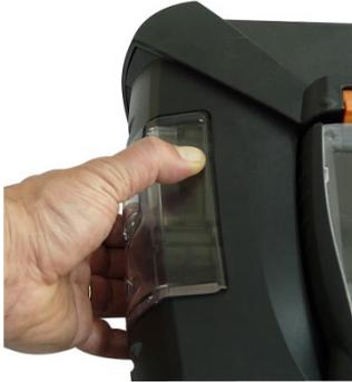
1. Kondensatbehälter am orangenen Griff an der Unterseite entriegeln.
