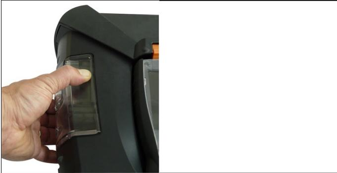
1. Desenganchar la trampa/el recipiente de condensados por el mango naranja de la parte posterior.
