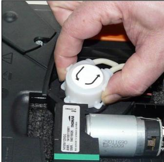
2. Desencajar ambos cierres de clip laterales de la bomba de condensados y levantar el cabezal de la bomba.
