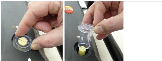
1. Abrir la cámara del filtro: Girar la tapa del filtro en sentido contrario a las agujas del reloj y retirar.
