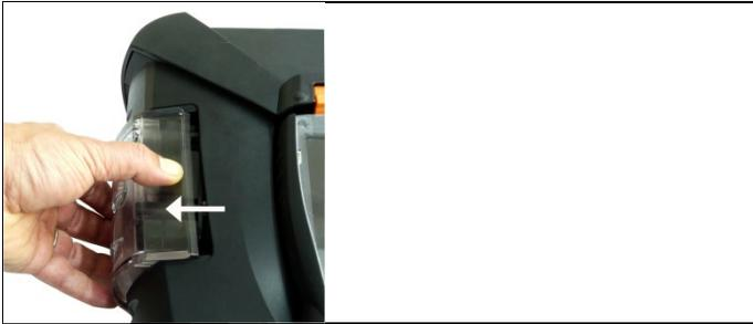
2. Retirar la trampa/el recipiente de condensados de la caja analizadora en horizontal.
