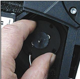
4. Soltar motor de la bomba de condensados (ligero giro en sentido contrario a las agujas del reloj).
