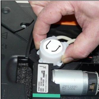
2. Desencajar ambos cierres de clip laterales de la bomba de alimentación del condensador y levantar el cabezal de la bomba.
