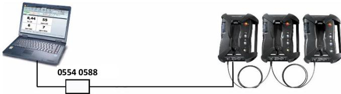
Se pueden conectar los distintos componentes (p.ej. Control Unit con caja analizadora o bien caja analizadora con caja analizadora) mediante el cable de bus de datos Testo a un sistema de bus.
