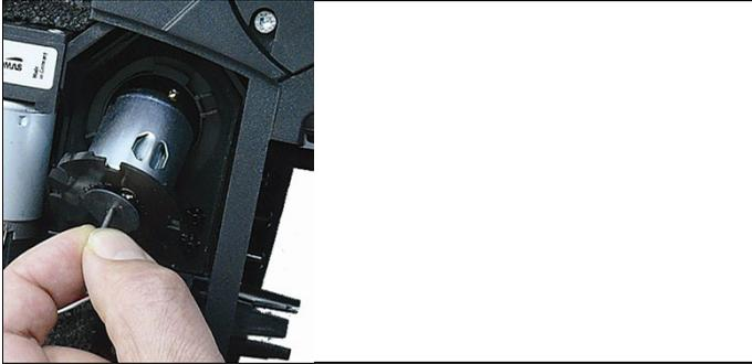
5. Sacar el motor de la bomba de condensados de la sujeción.
