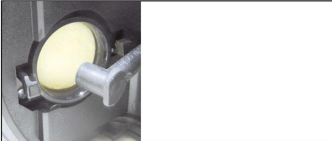
4. Sustituir el fieltro usado por otro nuevo.
