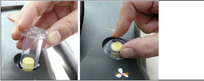
3. Colocar la tapa del filtro y cerrar girando en el sentido de las agujas del reloj. La muesca transversal de la tapa del filtro tiene que quedar paralela al mango.
