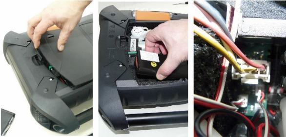
1. Abrir la tapa del compartimento de servicio (cierre de clip) situada en el lado trasero de la caja analizadora.
