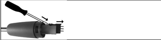
2. Con un destornillador suelte la cabeza insertable del termopar y extraiga el termopar del tubo de la sonda.
