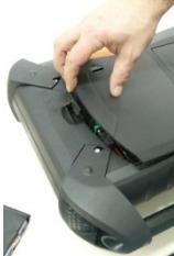
3. Deckel des Servicefachs (Clip-Verschluss) auf der Rückseite der Analysebox öffnen.
