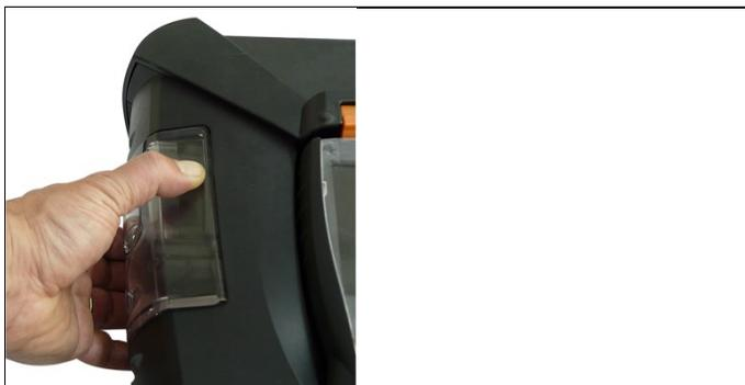
1. Kondensatfalle / Kondensatbehälter am orangenen Griff an der Unterseite entriegeln.
