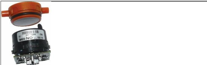
7. Neuen Filter auf den Sensor aufsetzen.
