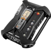
Die Control Unit kann auf die Analysebox aufgesteckt werden.
