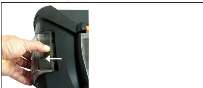
2. Kondensatfalle / Kondensatbehälter waagrecht von der Analysebox abziehen.
