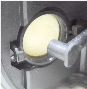
4. Verbrauchten Filter durch einen neuen Filtervlies ersetzen.
