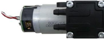
4. Die 4 Befestigungsschrauben (Torxschlüssel T 9) am Pumpenkopf der Hauptgaspumpe lösen.
