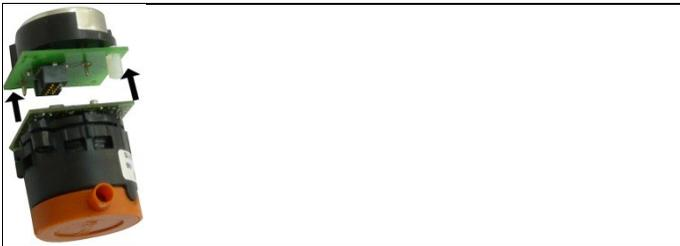
**i** Zusatzplatinen der neuen Sensoren erst unmittelbar vor dem Einbau entfernen. Sensoren nicht länger als 15 min ohne Zusatzplatinen liegen lassen.
