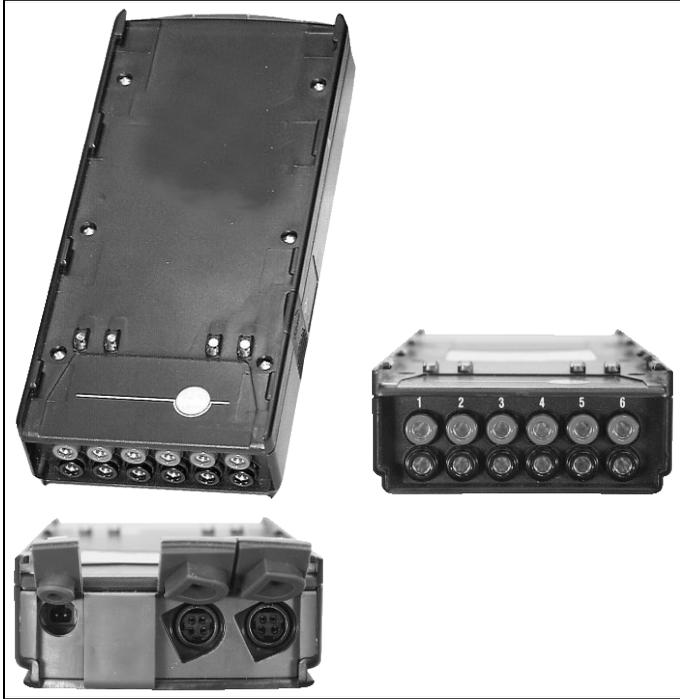
Über die Analogausgangsbox 0554 3149 (Zubehör) können bis zu 6 Messkanäle als Analogsignale (4 bis 20mA) ausgegeben werden. Die Analogausgangsbox wird über den Datenbus mit dem Gerät verbunden, die Konfiguration kann über die Control Unit erfolgen.
