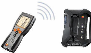
Die Control Unit kann mit einer Analysebox oder einem PC/Notebook über Bluetooth® verbunden werden, sofern beide Komponenten über diese Funktionalität verfügen, siehe **Bluetooth®**, Seite 55.
