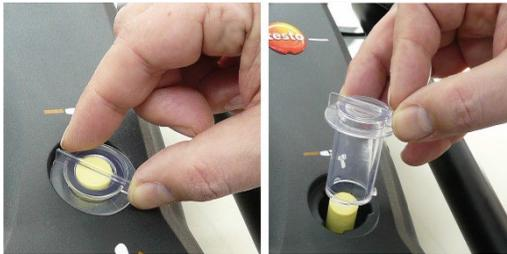
1. Filterkammer öffnen: Filterdeckel gegen den Uhrzeigersinn drehen und abnehmen.
