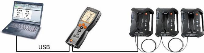
**i** Ist die Software testo easyEmission über eine Control Unit mit Analyseboxen verbunden, darf die Anzahl der Analyseboxen nicht verändert werden. Sollen neue Analyseboxen hinzugefügt werden, Software testo easyEmission beenden, neue Analysebox anschließen und Software testo easyEmission neu starten.
