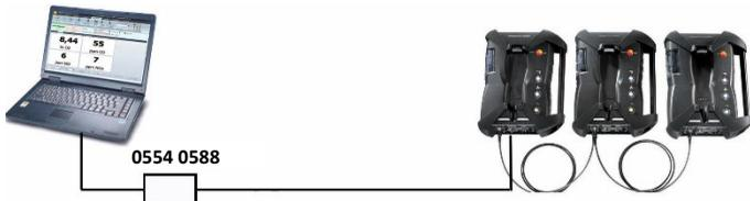
Die einzelnen Komponenten (z. B. Control Unit mit Analysebox oder Analysebox mit Analysebox) können über das Testo-Datenbuskabel zu einem Bus-System verbunden werden.
