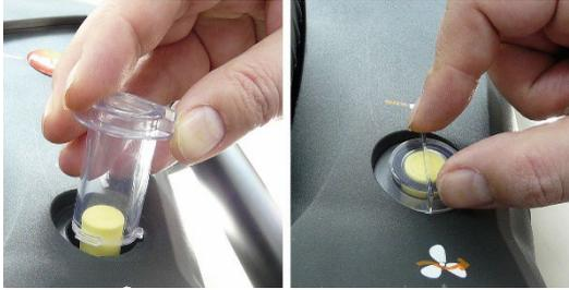
3. Filterdeckel aufsetzen und durch Drehung im Uhrzeigersinn verriegeln. Der Quersteg des Filterdeckels muss parallel zum Handgriff verlaufen.
