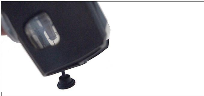
2. Laisser s'écouler le condensat dans un bassin.
