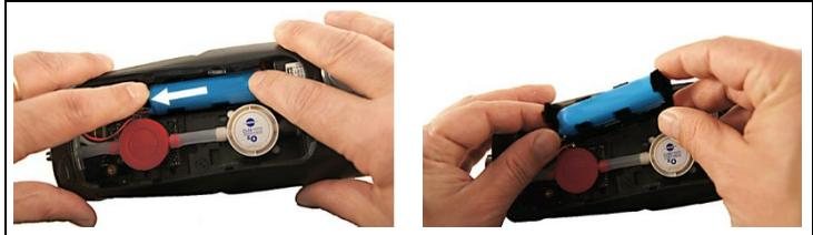
3. Comprimer légèrement le support avec les doigts. □ Tirer le clip de maintien dans le sens de la flèche jusqu'à ce que le blocage se desserre. Retirer le support.
