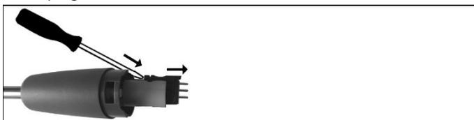
2. Détacher l'embout du thermocouple de son logement au moyen d'un tournevis et retirer le thermocouple du tube.
