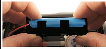
6. Installer un nouvel accumulateur dans le support. Veiller à ce que le câble de la fiche de raccordement passe sur le côté du support. Pousser l'accumulateur dans le support jusqu'à ce que les clips de maintien s'enclenche.
