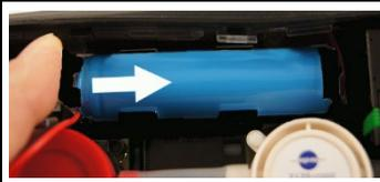
8. Mettre le support en place dans le rail de guidage et pousser dans le sens de la flèche jusqu'à ce que le support s'enclenche.
