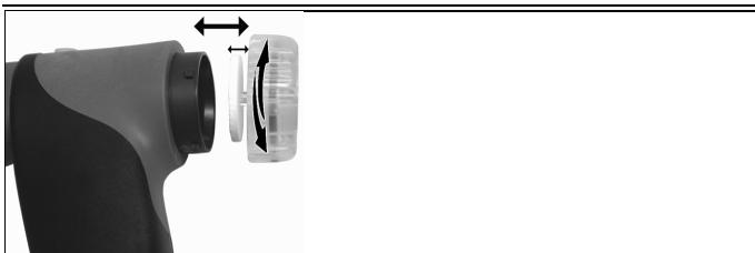
1. Ouvrir la chambre du filtre : tourner légèrement dans le sens contraire aux aiguilles d'une montre.
