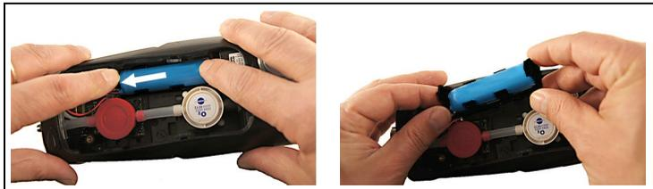
3. Halterung mit den Fingern leicht andrücken. □ Halteclip in Pfeilrichtung ziehen bis sich die Arretierung löst. Halterung entnehmen.
