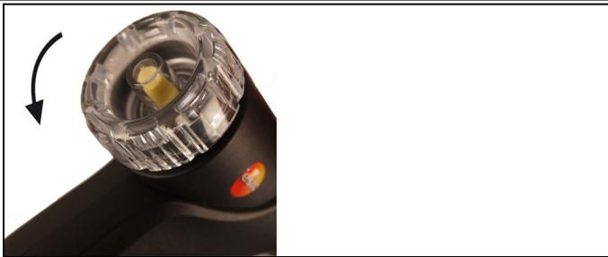
1. Ouvrir la chambre du filtre : tourner légèrement dans le sens contraire aux aiguilles d'une montre.
