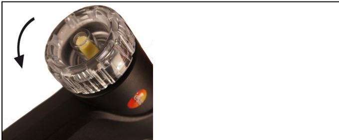
1. Ouvrir la chambre de filtration de la sonde de prélèvement de gaz : tourner légèrement dans le sens contraire aux aiguilles d'une montre.
