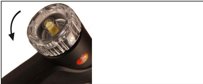
1. Aprire la camera del filtro: ruotare delicatamente in senso antiorario.
