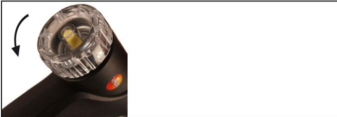
1. Aprire la camera del filtro della sonda per fumi: ruotare delicatamente in senso antiorario.
