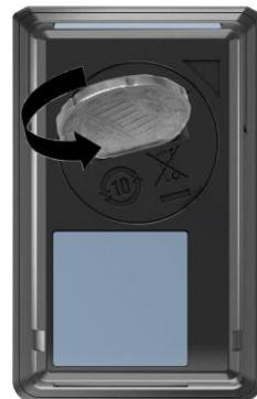
5 Inserire due batterie nuove (batterie a bottone da 3 V del produttore EVE, CR2032 al litio) in modo che il polo positivo di entrambe sia visibile.
