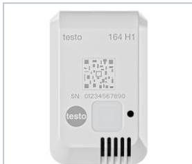
El testo 164 H1 es un registrador de datos en línea fácil de usar para la supervisión de temperatura y humedad con sensor integrado.
