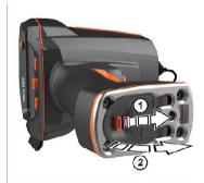
Empurre a pilha totalmente para dentro do espaço da pilha recarregável até que ela fique alinhada com a parte inferior da alça.
