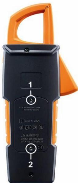
2. Usando uma chave de fenda, desaparafuse os dois parafusos de metal (1, 2) do compartimento de pilhas até ser possível remover a tampa do compartimento de pilhas. Não desaparafuse os parafusos completamente.
