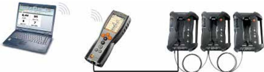
Bluetoothによる接続を行うためには、PC内のBluetoothモジュールとtesto350内のBluetoothモジュールの両方を起動する必要があります。青色の背景にBluetoothの白色のシンボルが表示されていればBluetoothはオンで、計測ボックスのBluetooth接続が確立していることを示します。
