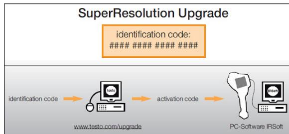
テストー社のウェブサイト([www.testo.com/upgrade](http://www.testo.com/upgrade))にアクセスするための識別コード(identification code)が書かれている封書が送られてきます。必要なデータをすべて入力すると、アクティベーション(有効化)コードが生成され、IRSoft PC ソフトウェアを通じて機能の有効化が可能になります。ウェブサイトに書かれていくインストレーションに関する必要事項や手順を遵守してください。
