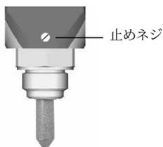
1 プロセス接続口(G $\frac{1}{2}$ あるいはNPT $\frac{1}{2}$ " )をプロセスの取り付け穴にねじ込みます。
