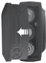
計測中に、ディスプレイ上に 記号が表示されたら、バッテリの交換が必要です。
