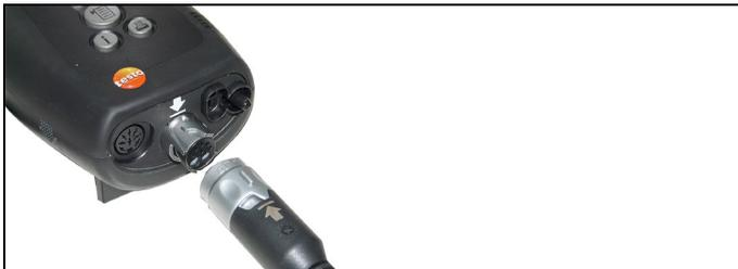
> コネクタを排ガス・ソケットに挿入し、ゆっくりと時計周りに回してロックします。(バヨネット・ロック方式になっています)
