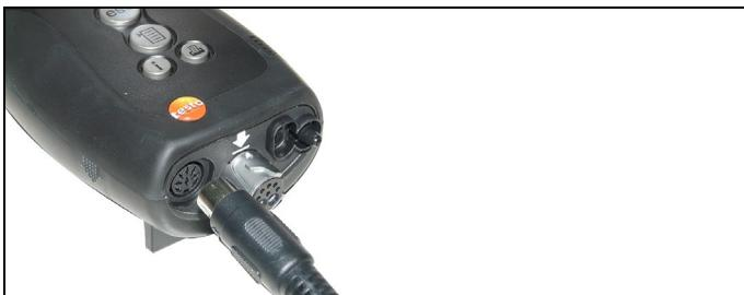
> プローブのコネクタをプローブ・ソケットに接続してください。
