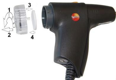
1. フィルタ・チャンバーを反時計方向に回して、取り外します。
