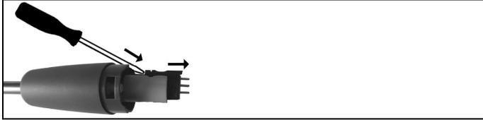
2. ドライバー等を使用して、熱電対のプラグイン・ヘッドをソケットから外し、熱電対をプローブ・パイプから引き抜きます。(上図参照)
