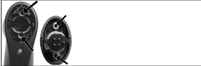
2. プローブ・モジュールとプローブ・ハンドルの排ガス・ダクト(上図参照)から圧縮空気を吹き込み、汚れを吹き飛ばします。ブラシは使用しないでください。
