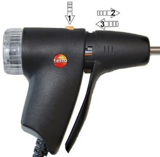
1. プローブ・ハンドルの頂上にあるボタンを押して、プローブ・モジュールを取り外します。
