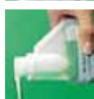
バッファ液ボトルを傾けて、使用したバッファ液を捨てます。使用後は、バッファ液ボトルのキャップをきちんと締めて保管してください。
