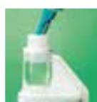
試験容器部分に直接pH液を入れ、校正・調整を行います。校正・調整の方法については、pH計の取扱説明書の指示に従ってください。
