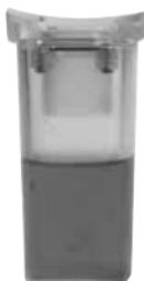
保管用キャップには電極表面の乾燥を防止するための電解質ゲルが入っています。計測を行わないときは必ずプローブをこのキャップに入れておいてください。プローブがすぐに使用できるのは、電極部が電解質ゲル中に入っていた時だけです。プローブを電解質ゲルから長時間出したままにして、電極表面が乾燥してしまったときは、仕様前に電解質ゲル中に約12時間入れておく必要があります。
