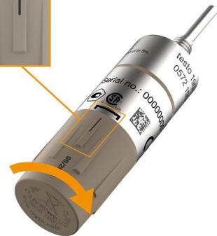
▶ 電池側の「凸型」目印が、ロガー側の「コの字」の目印の範囲内に収まるよう電池を締めます。
