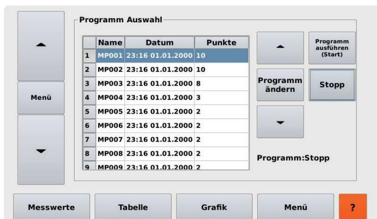
右側の矢印キーでプログラムを切り替えることができます。また、タッチディスプレイで目的のプログラムを直接選択することもできます。プログラムがマークされている (青くハイライトされている) 場合は、右側のボタンを使用して変更、開始、停止することができます。
