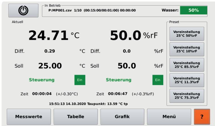
Huminator II が測定を開始するとすぐに、プログラム番号の横にカウンターが表示されます。これは、Huminator II が現在どのポイントを通っているか、その後に何ポイント残っているかを示しています。プログラムは「Stop (停止)」で終了させることができます。
