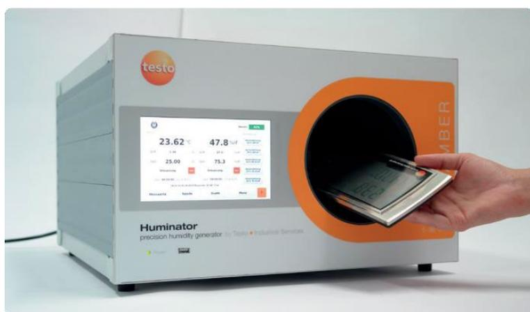
チャンバー内に搭載されたファンにより、空気を均一に分布させます。さらに、高精度な静電容量式の温湿度センサをチャンバーに内蔵しています。
