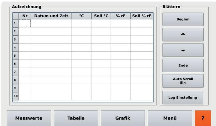
プリセットされている「Auto Scroll (オートスクロール)」では、最後に記録された値が常に表示されます。「Auto Scroll Off (オートスクロールの解除)」を押すと、連続更新が無効になり、表示が固定されます。ただし、データの記録はバックグラウンドで継続されます。「Auto Scroll (オートスクロール)」を再び有効にすると、表示は最後に記録された値に変わり、継続的に更新されます。「Start (最初)」は最初に記録された値に、「End (最後)」は最後に記録された値に移動します。矢印キーで記録の上下に移動することができます。
