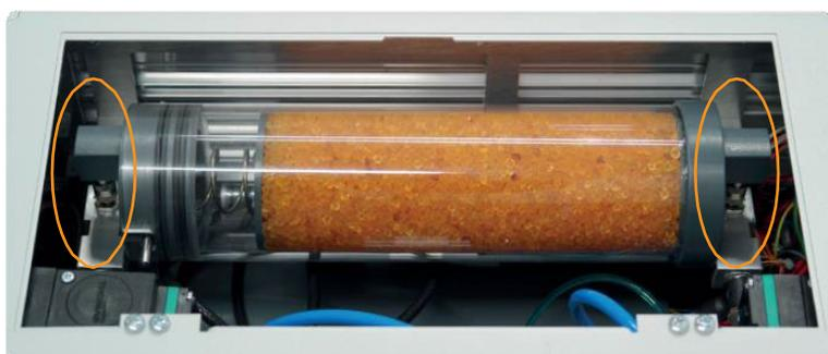
6. クイックリリースの外輪を上へ引き、2つのクイックリリースを解除します。
