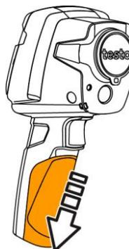
3 - Déverrouiller la batterie et la retirer.
