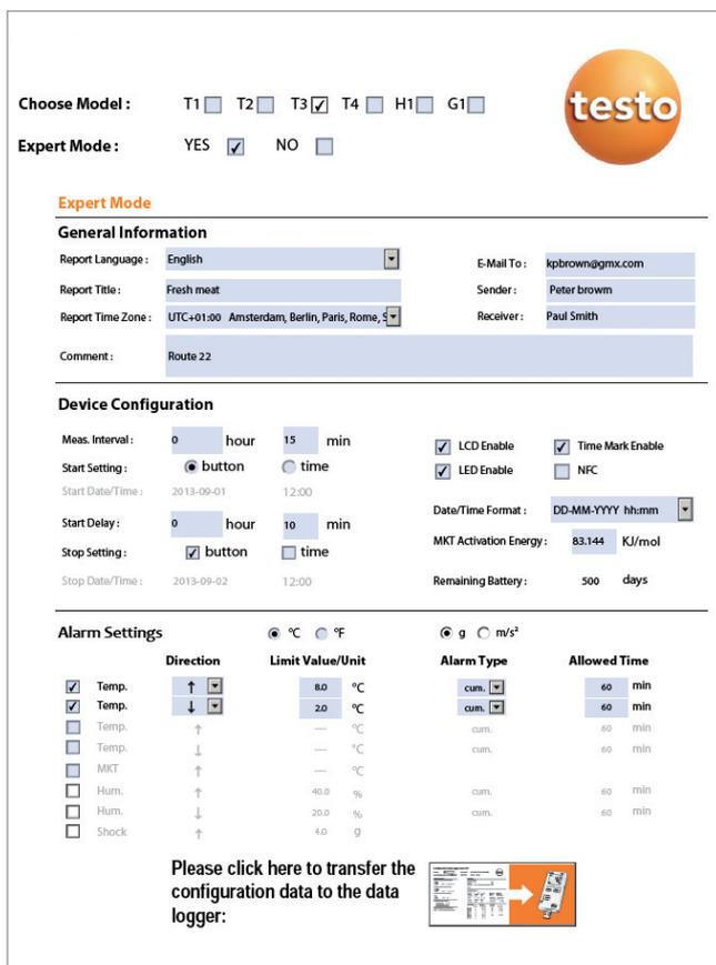
Non è necessaria l'installazione di un software su PC o su notebook per configurare un data logger Testo 184. Lo strumento di configurazione PDF è salvato nel logger stesso ed è sufficiente un doppio click per aprirlo.
