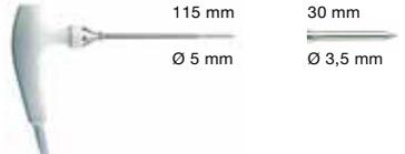
115 mm 30 mm<br>Ø 5 mm Ø 3,5 mm | -25... +150 °C <sup>2)</sup> | ±0,5% del v.m.<br>(+100... +150 °C)<br>±0,2 °C (-25... +74,9 °C)<br>±0,4 °C (rimanente campo di misura) | 7 s               | 0615 2411 |
