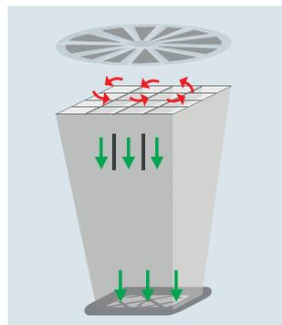
Principio di funzionamento del raddrizzatore di flusso.
