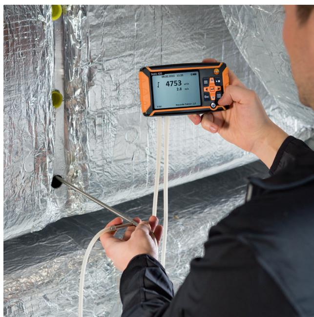
Lo strumento rimovibile consente di effettuare misure con tubo di Pitot nei condotti (tubo di Pitot disponibile separatamente)
