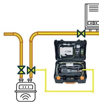
**La UNI 11137 può essere fatta con aria o con gas su impianti esistenti, sia sotto che sopra i 35 kW,** appartenenti alla 6° o 7° specie. La prova si fa in modalità diretta, che è il metodo più veloce e ripetibile, sia con aria che con gas, usando il singolo strumento e/o il kit con serbatoio. E la prova dura solo 1 minuto!
