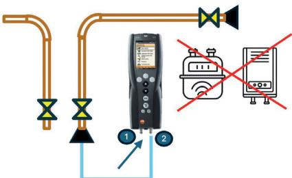
Tramite l'ingresso 1 lo strumento preleva aria e mette in pressione l'impianto. In automatico esegue la prova.
