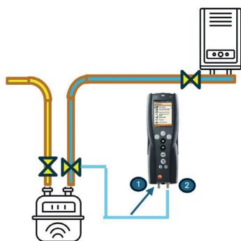
È possibile eseguire la prova sia con aria (solo strumento t324) che con gas (kit t324 con serbatoio).
