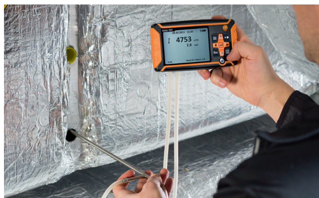
A kivehető műszer lehetővé teszi a Prandtl-csőves méréseket a csatornában (Prandtl cső külön kapható)
