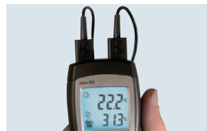
Registro simultáneo de la temperatura por dos sondas conectadas y visualización de la presión diferencial
