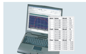
Analizar y documentar los valores por situación de medición con el software para PC (incluido en la entrega del testo 735-2)
