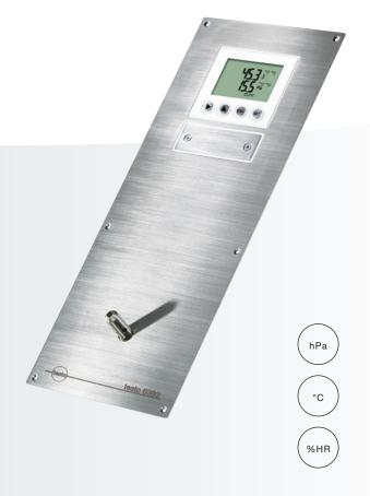
Le transmetteur de pression différentielle testo 6383 a été spécialement conçu pour la surveillance des faibles pressions différentielles dans une étendue de mesure allant de 10 Pa à 10 hPa. Dans les salles blanches, le maintien d'une surpression dans la zone critique empêche la pénétration d'air pollué. Grâce à une sonde interne ou externe de la gamme de sondes testo 6610, disponible en option, la mesure simultanée de l'humidité et de la température est en outre possible avec un seul appareil.
