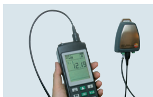
Inspección de transmisores con interfaz de 4 a 20 mA
